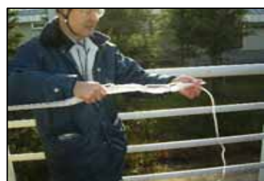
ロープを切り込みに通し固く縛り ハーフヒッチを作る
