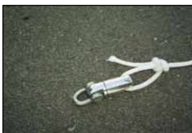
ロープの端部に撚り戻し金具をつける もう一方の端部にガイドロープを結ぶ
